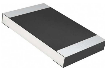
FIGURE 3.51 – Vue d'une résistance montée en surface
