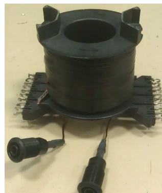
(b) Inductance à air réalisée permettant de diminuer les capacités parasites
