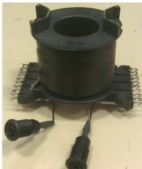
FIGURE 3.36 – Inductance réalisée à air permettant de diminuer les capacités parasites
