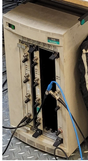
FIGURE IV.4 – Système Nicolet Multipro pour trigger la caméra ultra rapide Shimadzu
