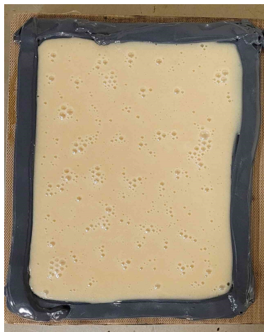
FIGURE III.7 – Plaque de résine Hexply®M21 après la première étape de dégazage manuel
