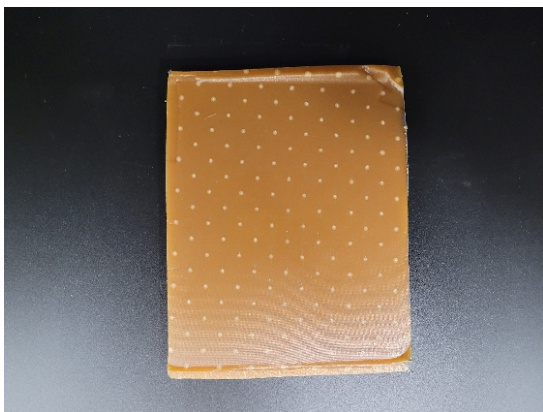
FIGURE III.12 – Plaque de résine Hexply®M21 après cuisson
