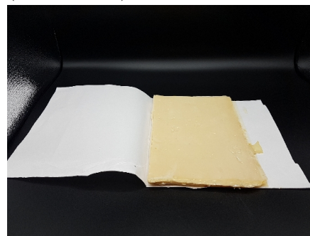
(d) Plaque de résine regroupant quatre films de résine pliés en 4 de 125 \times 200 \text{ mm}^2 ( e \approx 6.4 \text{ mm} )
