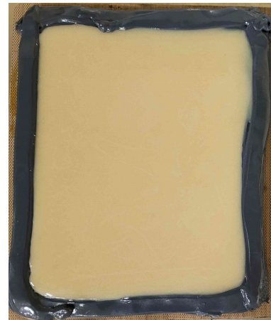
FIGURE III.8 – Plaque de résine Hexply®M21 avant cuisson
