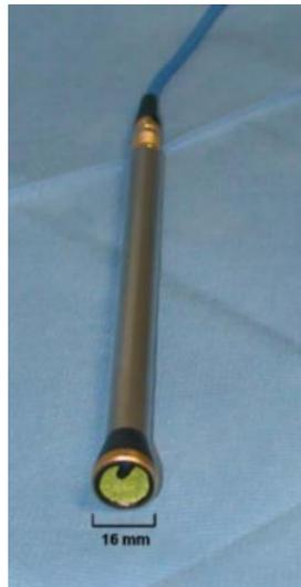
Figure 12 : sonde de détection des particules  $\beta^+$ <sup>89</sup>
