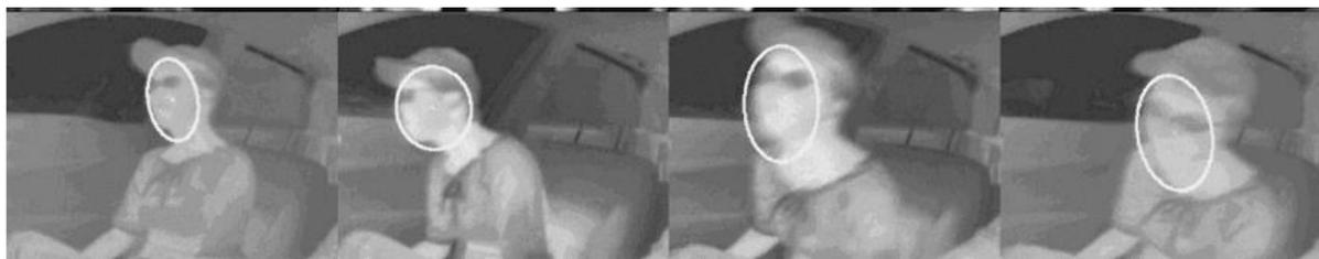
Figure 18. Système d'airbag intelligent [32]. Une caméra *LWIR* est utilisée pour détecter le visage. La taille et la position de l'ellipse sont utilisées pour déterminer si le passager est dans une zone dangereuse en cas de déclenchement d'airbag.
