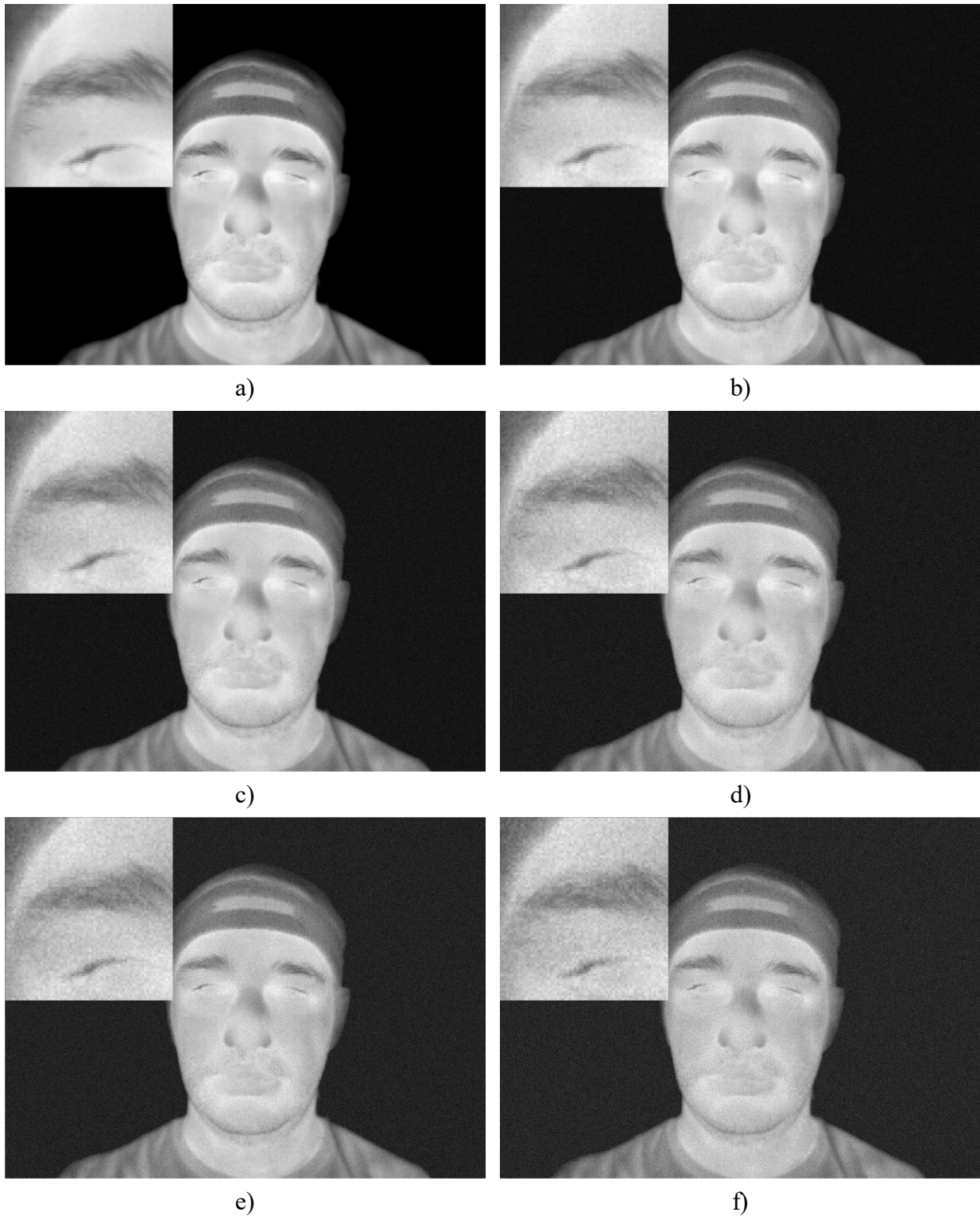
Figure 148. Ajout d'un bruit simulé sur l'image initiale de la caméra Gobi pour atteindre des niveaux de NETD supérieurs. a) Image initiale NETD = 60 mK, b) NETD = 150 mK, c) NETD = 200 mK, d) NETD = 250 mK, e) NETD = 300 mK, d) NETD = 350 mK.
