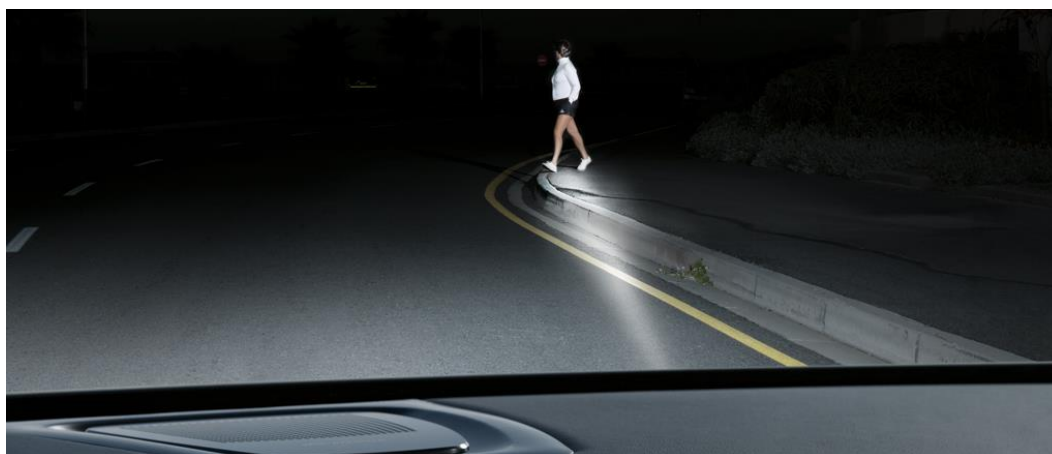
Figure 16. Système d'éclairage dynamique de piéton proposé par BMW et Autoliv [38]. Une caméra LWIR détecte le point chaud, et un éclairage visible dynamique éclaire par impulsion le piéton.
