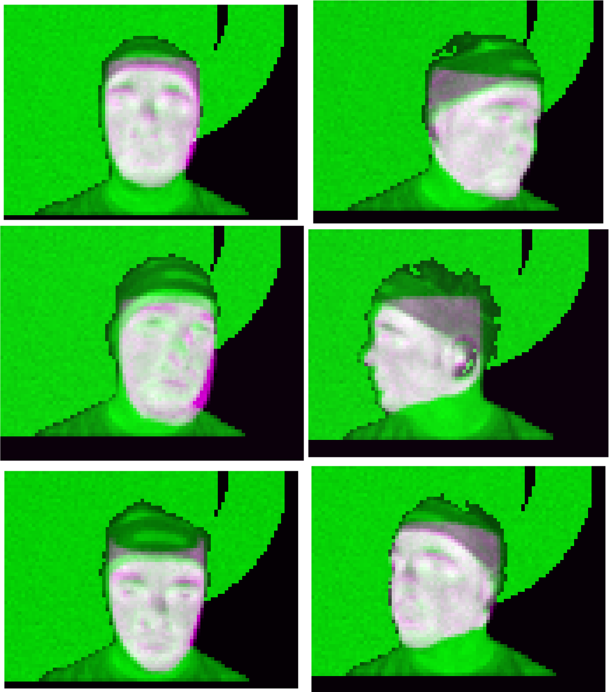
Figure 155. Superpositions des images réelles et des images de synthèse (en rose) qui représentent le mieux l'orientation selon les angles yaw et pitch . Un format 80×60 et une NETD de 120 mK ont été simulés à partir de l'image réelle acquise par la caméra Gobi .
