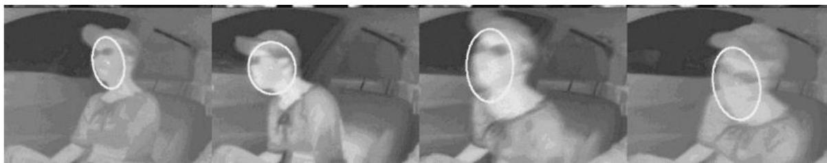
Figure 18. Système d'airbag intelligent [32]. Une caméra LWIR est utilisée pour détecter le visage. La taille et la position de l'ellipse sont utilisées pour déterminer si le passager est dans une zone dangereuse en cas de déclenchement d'airbag.
