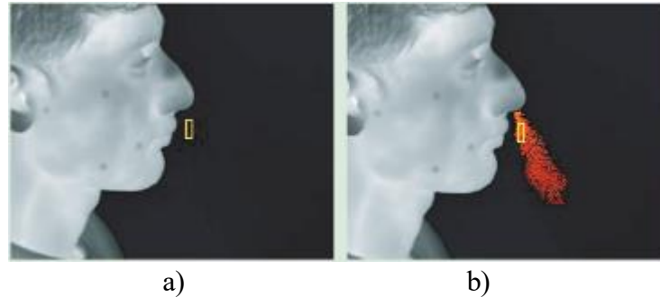
Figure 21. illustration de la zone d'intérêt permettant d'évaluer le rythme respiratoire [51]. a) L'individu n'expire pas. b) L'individu expire de l'aire.
