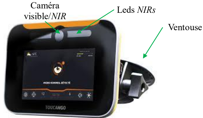
Figure 6. Système de surveillance du conducteur par caméra Toucango de la société InnovPlus [23]. Ce système se fixe sur le pare-brise grâce à une ventouse à la manière d'un GPS.
