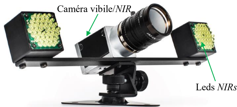
Figure 5. Système AntiSleep proposé par la société SmartEye en 2014 [22]. Une caméra sensible dans la bande visible et NIR est associée à deux groupes de Leds placés à gauche et à droite de la caméra.
