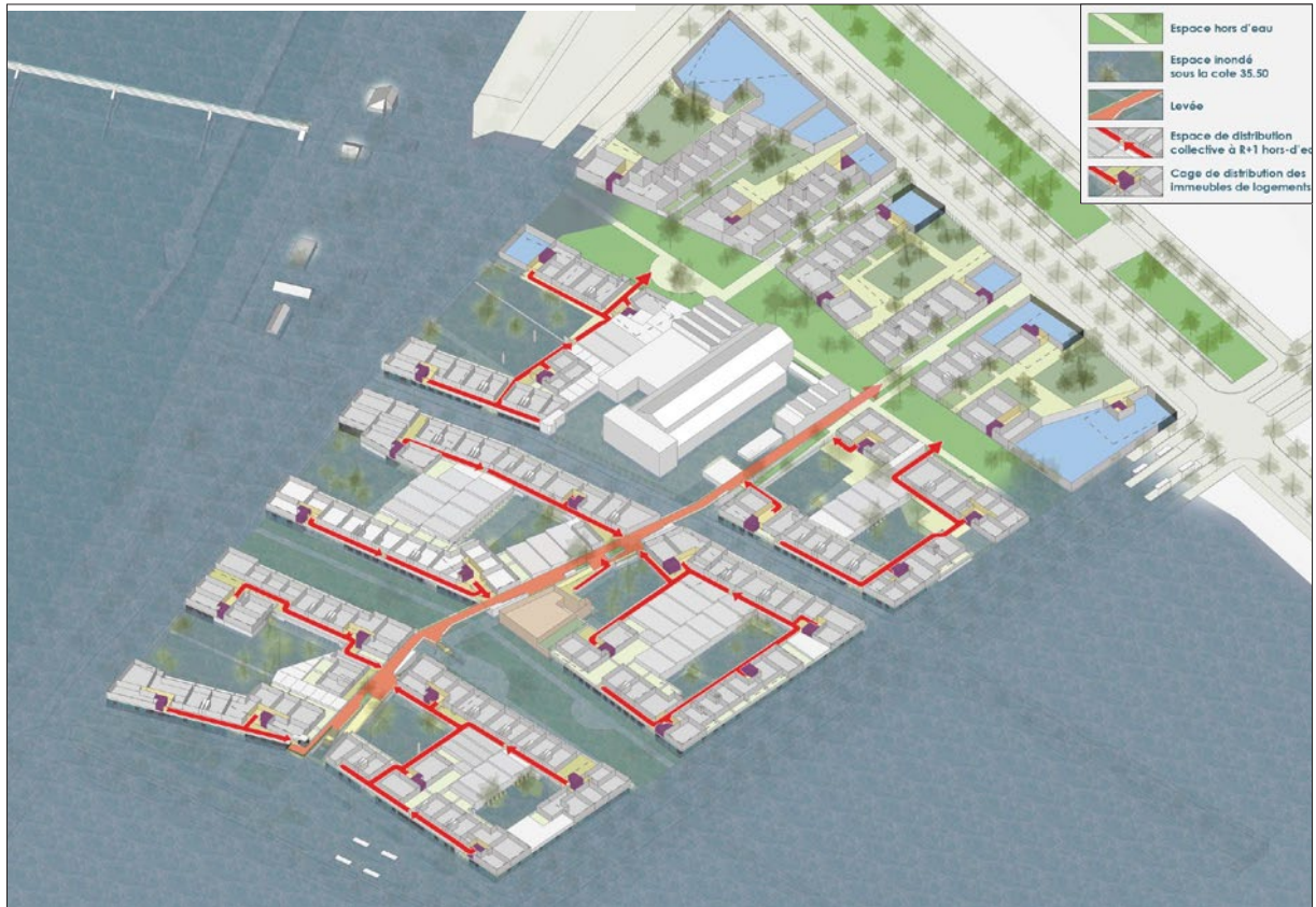
Figure 246 : Principe d'accessibilité hors d'eau en situation de crue centennale, ZAC Seine-gare-Vitry - Source : EPA ORSA / Germe&JAM, MAGEO, Agence Hilaire, ZOOM. Plan de référence, Décembre 2014.
