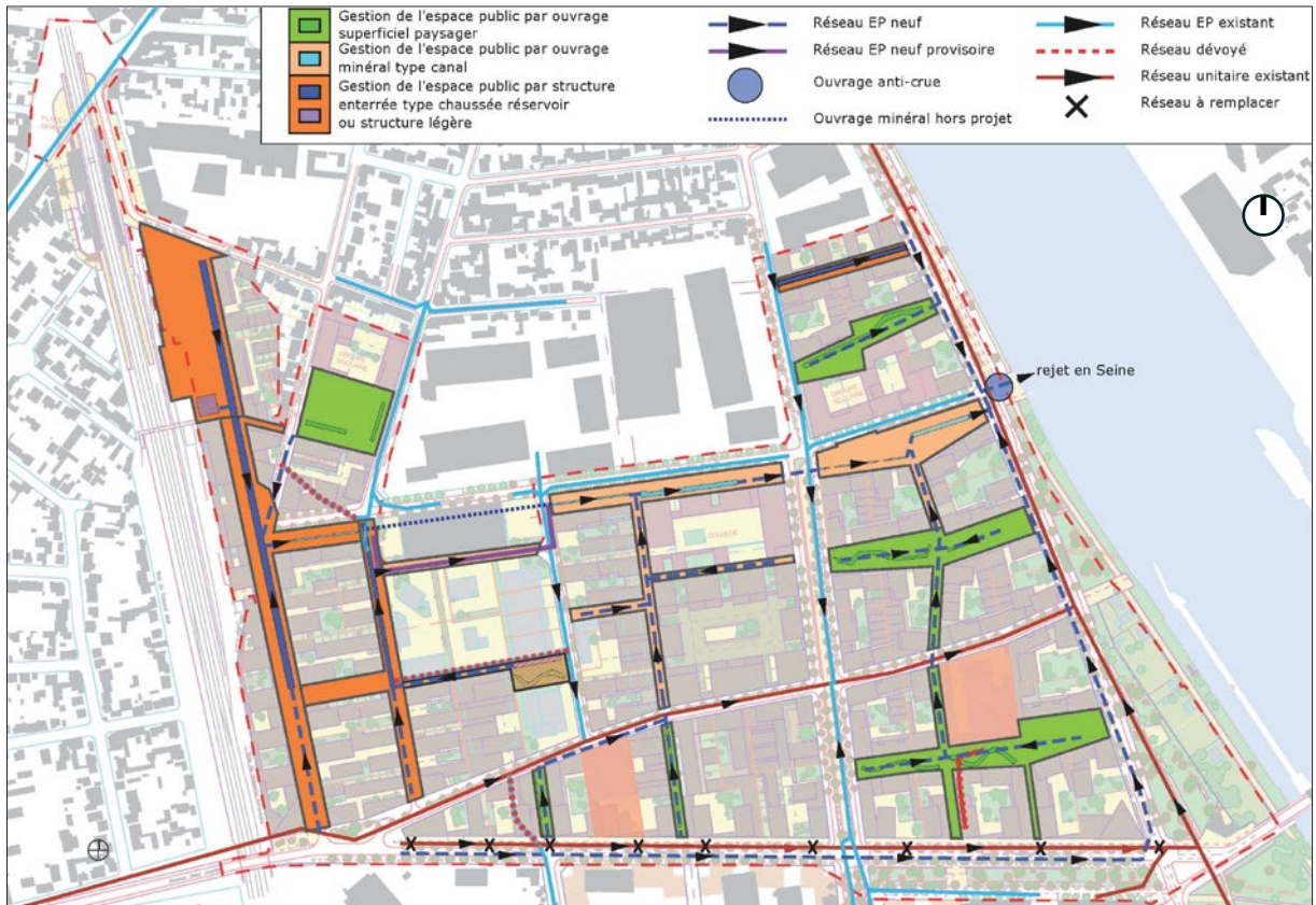
Figure 230 : Schéma de gestion des eaux pluviales dans l'espace public, ZAC Seine-gare-Vitry - Source : EPA ORSA / Germe&JAM, MAGEO, Agence Hilaire, ZOOM. Plan de référence, Décembre 2014.
