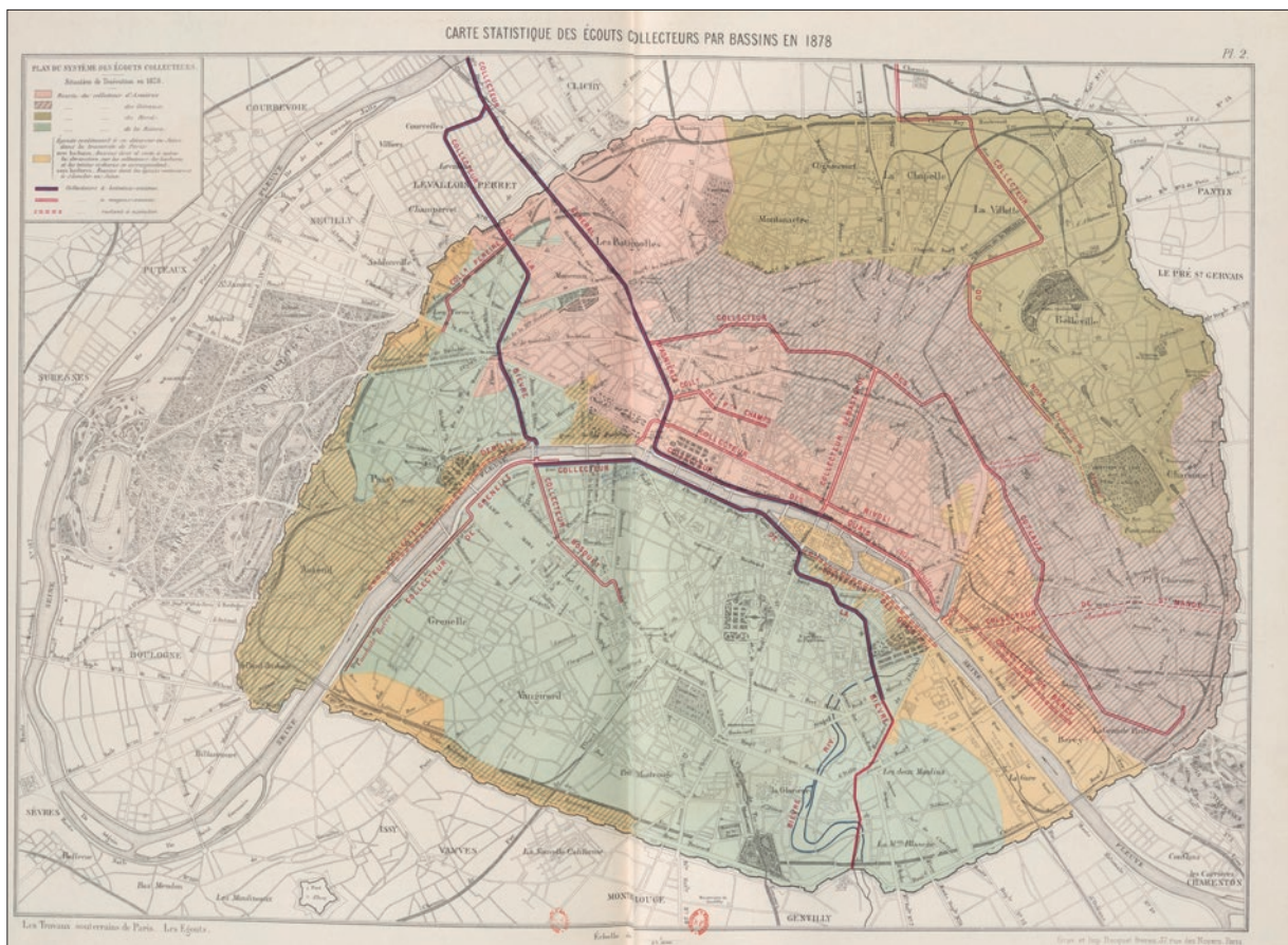
Figure 196 : Carte statistique des égouts collecteurs par bassins en 1878 ; Les travaux souterrains de Paris, ATLAS, Tome 5, par M. Belgrand, 1872- 1887 - Source : gallica.bnf.fr, Bibliothèque Nationale de France.
