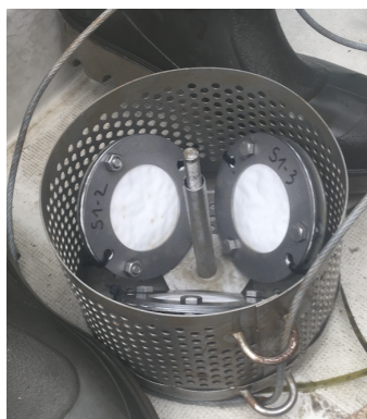
Annexe 1.7: Descriptif des POCIS (Polar Organic Chemical Integrative Sampler) avec (a) la gamme de log Kow accumulée sur des POCIS (Tiam, 2013), (b) la photo d'un POCIS dans son support, et (c) la représentation schématique de la composition des différents composants (Mazellier et al., 2018).
