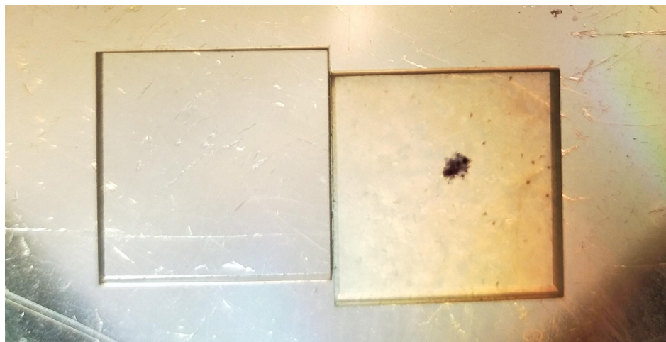
FIGURE 2.16 Effet de l'altération sur la couleur perçue. Le verre de gauche est celui avant altération, à droite celui après altération. La marque noire est un point de repère pour d'autres analyses.
