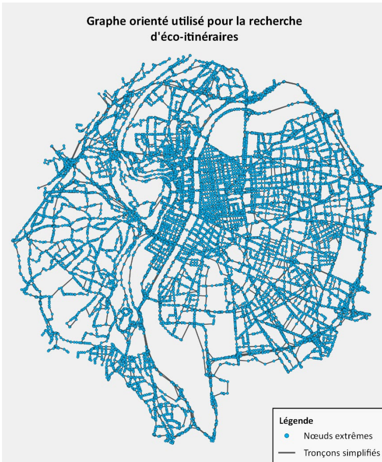
Figure 51 : Graphe orienté composé de 22 796 tronçons utilisé pour la recherche d'éco-itinéraires.
