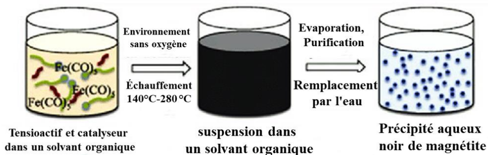
Figure 1.16: Synthèse des nanoparticules magnétiques d'oxyde de fer par décomposition thermique.
