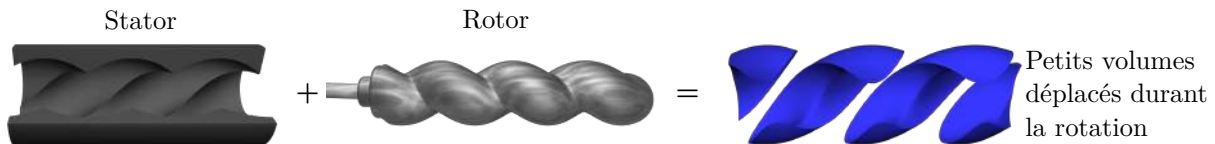
FIGURE 3.11 – Illustration du principe de fonctionnement d'une pompe à cavité progressive (source).
