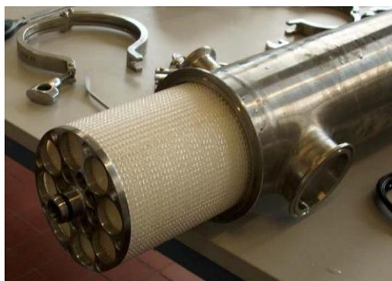
**Figure II. 4.** Membrane spirale 4333 (dite 4 pouces) dans le carter inox du pilote (6.8 m<sup>2</sup>).
