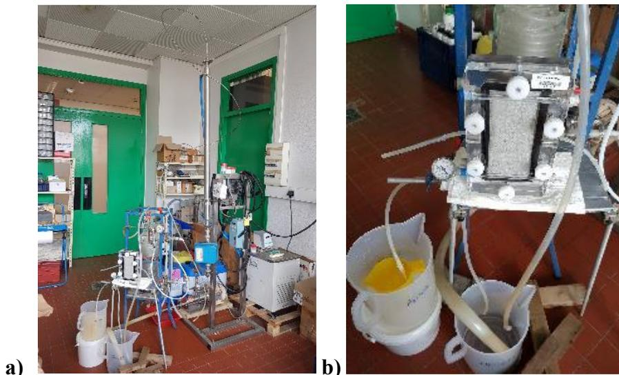
Figure II. 2. Photographies (a) du pilote UF-LPS, (b) du module Plan Ray Flow X-100
