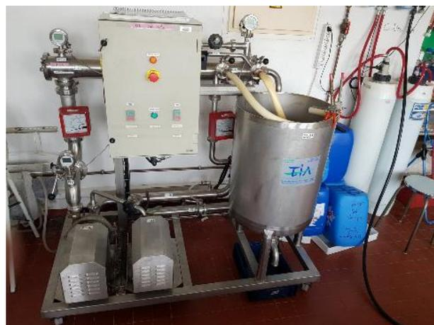
**Figure II. 6.** Pilote spiral fabriqué par TIA (Bollène, France) équipé d'un module spirale 4333 (HFK-131, Koch, espaceurs diamant 31 mil).
