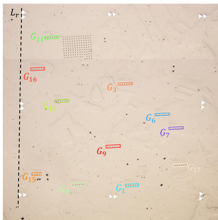
Figure 2.11 : Zone d'étude pour les essais d'indentations avec la numérotation des différentes zones. La colorisation des zones est faite en respectant le code couleur TSL présenté à la Figure 2.4. Les marques de repérage sont présentées en blanc. La ligne en pointillé L_r est une référence pour repérer l'orientation de l'indenteur.
