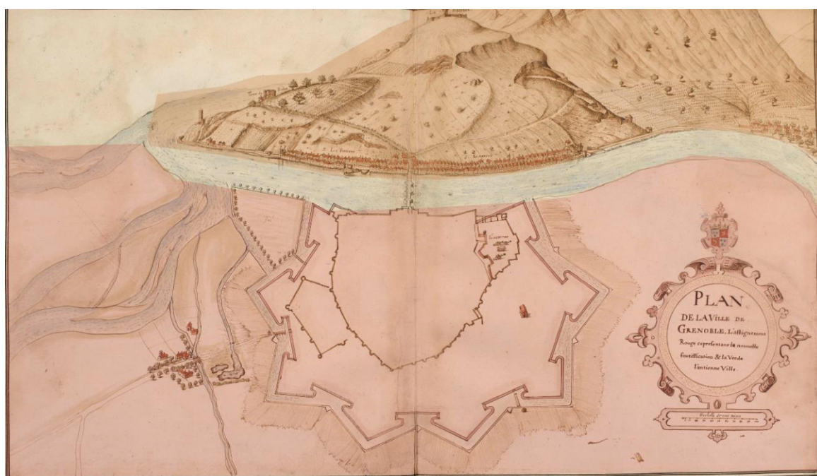
Figure 34 – Le mélange de plan (zone rouge) et profil (zone orange) sur le Plan de la ville de Grenoble
