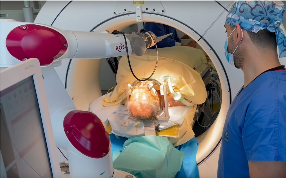
(b) Phase préopératoire du recalage de la trajectoire d'insertion lors d'une SCP au CHU de Rennes. La progression intra-crânienne des outils de mesure et de stimulation est ici assurée par le robot ROSA®, associé à un imageur 3D peropératoire de type O-arm (Source : Ouest France)
