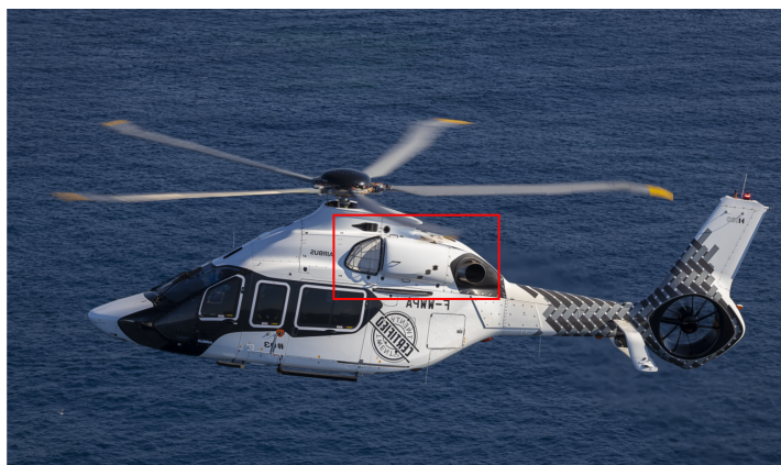
FIGURE I.3 – Localisation du moteur sur hélicoptère (Airbus H160)
