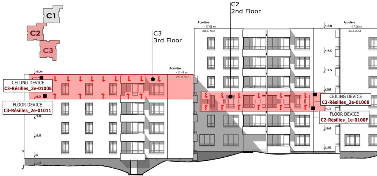
Figure 15 : Mesure de la consommation électrique des planchers chauffants
