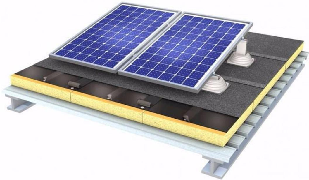
Figure 54 : Principe du système de plots thermosoudés
