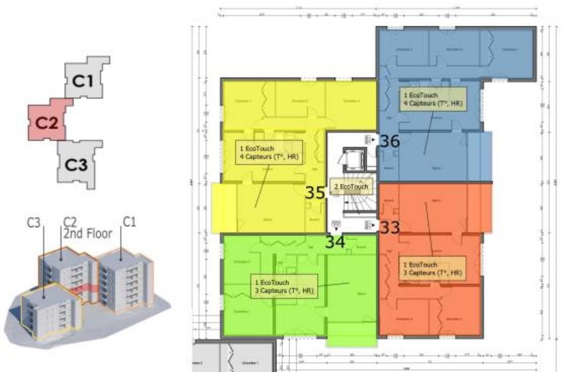
Figure 12 : Instrumentation du R+2 - bâtiment C2
