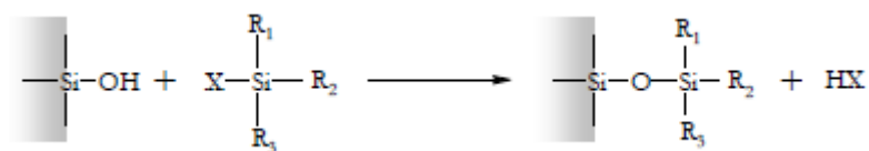
Figure 12: Réaction de greffage sur un silanol
