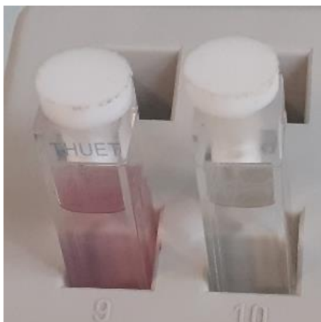
Figure 4.4 : Photographie de cuvettes en quartz contenant le Bodipy [3] dans du DCM à C = 1,3 \times 10^{-6} \text{ mol.L}^{-1} . (Gauche) pas d'ajout d'acide. (Droite) Ajout de 100 \mu\text{L} d'acide trifluoroacétique.
