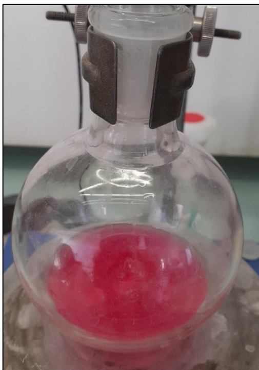
Figure 2.1.6. Allure du mélange réactionnel avant ajout du méthanolate de sodium lors de la synthèse du C 6 -C 2 -50 fonctionnalisé à la tétrazine (C 6 -C 2 -50-Tz).
