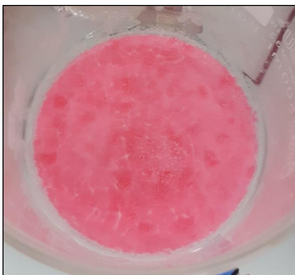
Figure 2.1.7. Allure du polymère C 6 -C 2 -50-Tz après la première précipitation en milieu acide, puis filtration sur fritté (porosité 4).
