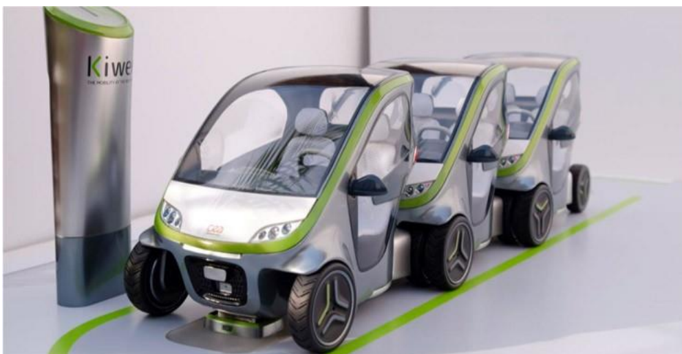
Figure 44 Un système de voitures électriques emboîtables (source : Metacar Mobility Systems)
