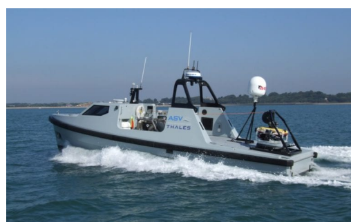
Figure I.10 – USV C-Sweep d'ASV
