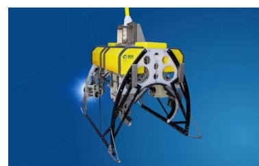
(c) ROV pour inspection de câbles et pipelines : RIS 2000 d'Eca Group
