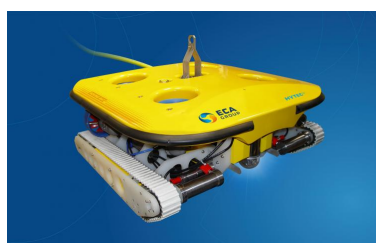
(b) Crawler pour inspection de coques et de structures immergées : ROVINBAT d'ECA Group
