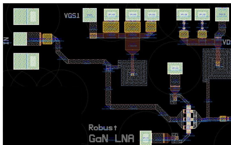
Figure 79 : Layout du 1 er étage du LNA deux étages en configuration cascade
