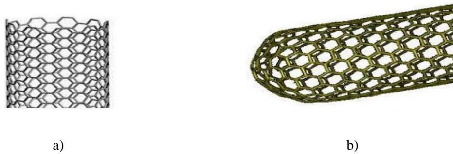
Figure 8 : Types de nanotubes de carbone en fonction du type d'extrémité a) ouvert et b) fermé [97]
