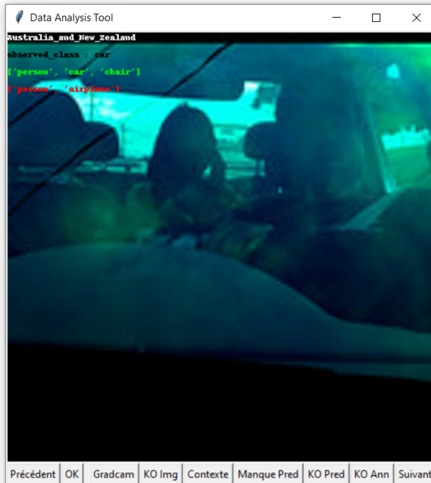
Figure 43: Interface de l’outil d’évaluation présentée à l’opérateur et développé par mes soins. De multiple boutons permettent de naviguer et d’annoter les données visualisées ainsi que les annotations et prédictions pour chacune de ces données.
