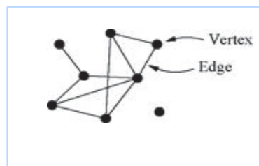
Figure 11. La représentation d'un réseau, simple, avec 8 nœuds (Vertex) et 10 bords (Edges)
