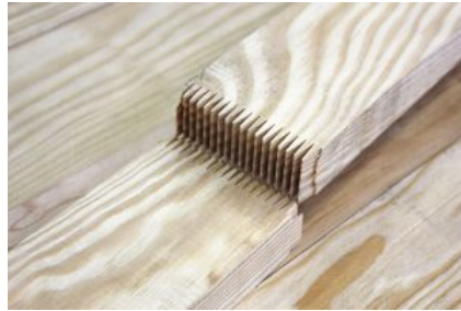
FIGURE 3.7 – Illustration de l’aboutage réalisé chez l’entreprise GB pour la production de LCAs 3 .
