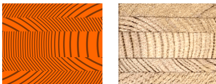
FIGURE 4.12 – Rappel de la séquence d’empilements de la configuration GE5-1 : FD+/ FD-/Q/FD+/FD-.
