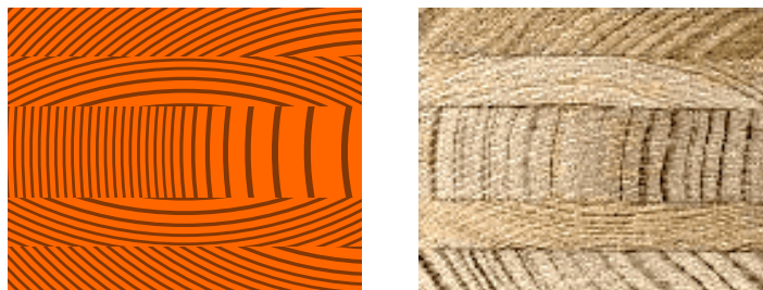
FIGURE 4.20 – Rappel de la séquence d'empilements de la configuration GE5-3 : FD/D/Q/D/FD.
