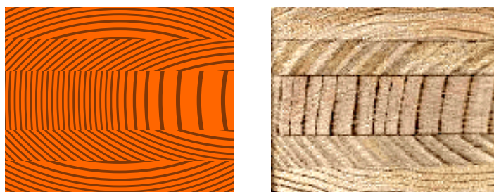
FIGURE 4.24 – Rappel de la séquence d'empilements de la configuration GE5-4 : D/FD/Q/FD/D.
