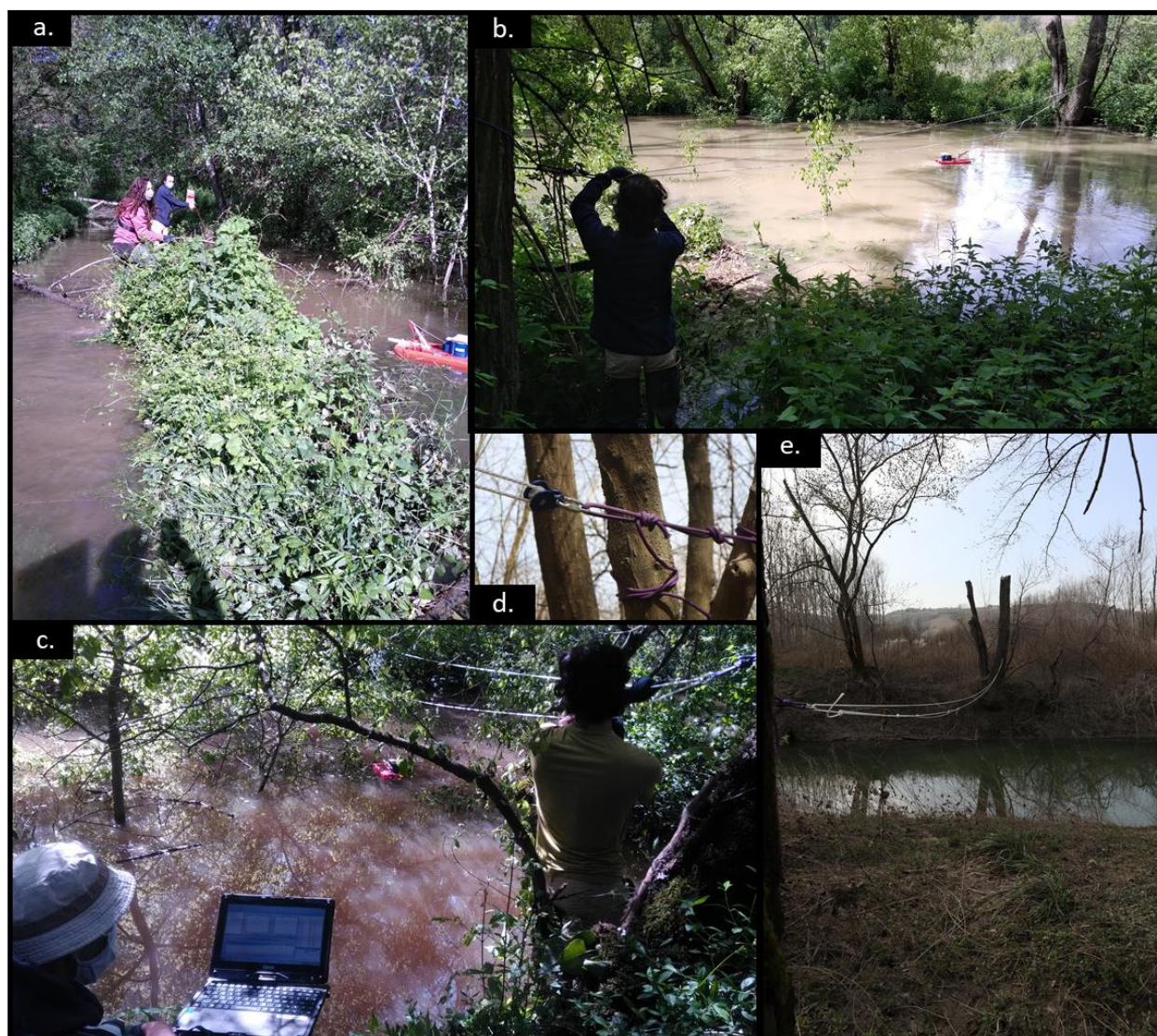
Annexe 11 : Planche photographique de la réalisation de la campagne aDcp sur les bras secondaires avec (a) le site de Limony aval et le seuil aval submergé, le site de l'Ilon (b) lors de la crue de mai et (e) en période d'étiage, (c) le site de Limony amont et (d) un zoom sur l'installation comprenant une petite poulie
