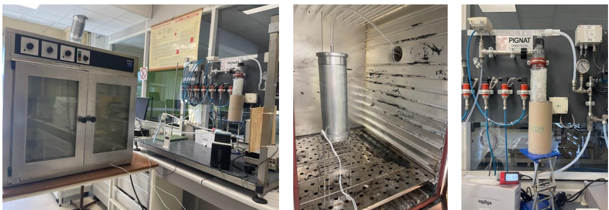
Figure II- 10: Photographies du procédé SVE thermiquement améliorée (T-SVE)
