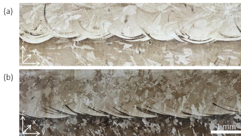
Figure II-17. Images au microscope optique après attaque Adler de l'interface 100% Ni625 / 80% Ni625 + 20%Fe en coupe : (a) transverse-XZ et (b) longitudinale-YZ.
