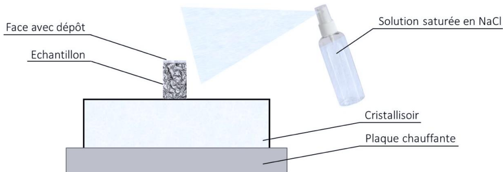
Figure II-12. Dispositif permettant de réaliser les dépôts solides de NaCl.
