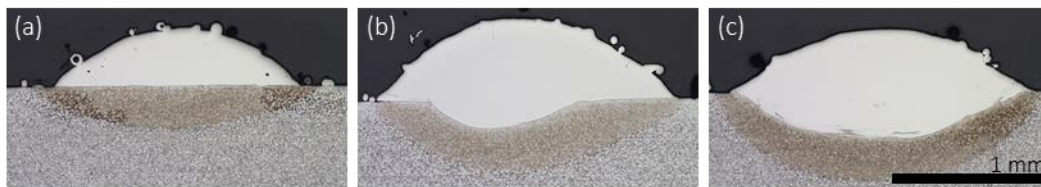
Figure II-4. Images en coupe transverse de mono-cordons illustrant la catégorie, (a) collage, (b) tête de clou et (c) bon cordon.
