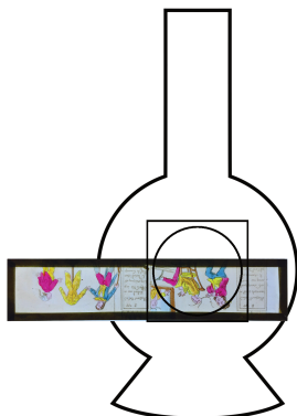
Figure 17. Schéma d'une lanterne de face. La plaque insérée est moins haute que le passe-vues.
