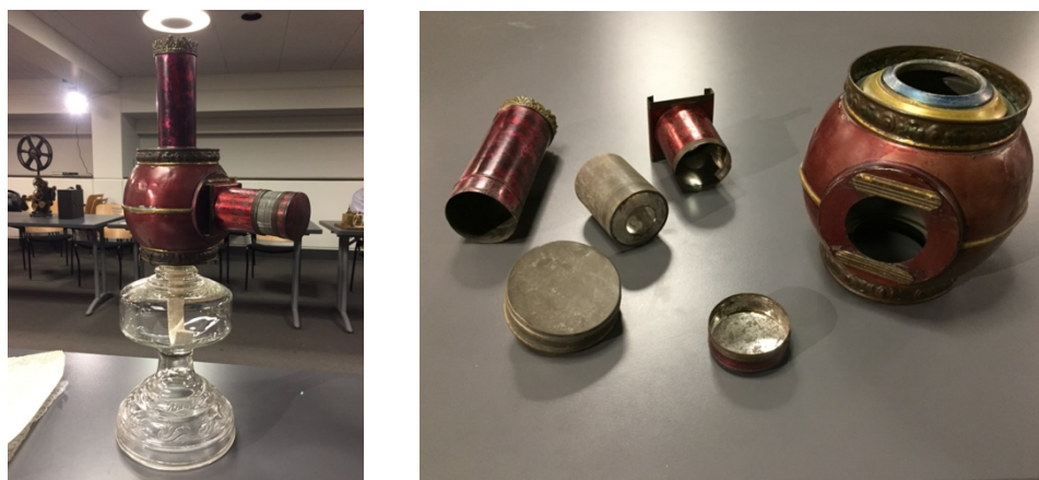
Figure 4. Un lampascope boule Lapierre, monté sur une lampe à huile (à gauche), et démonté (à droite). (Collection François Lemai, Université Laval).
