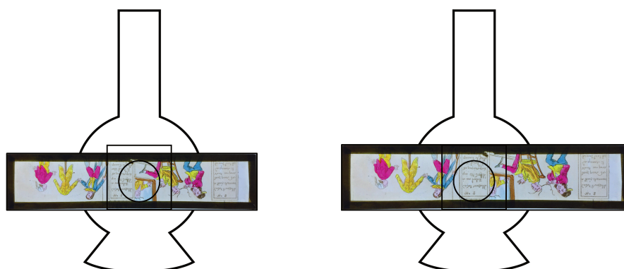
Figure 19. Schémas de projection d'une plaque (de face). À gauche, la section projetée est centrée sur la hauteur de la plaque, à droite, avec une plaque trop grande, la section projetée est décentrée vers le haut de l'image.
