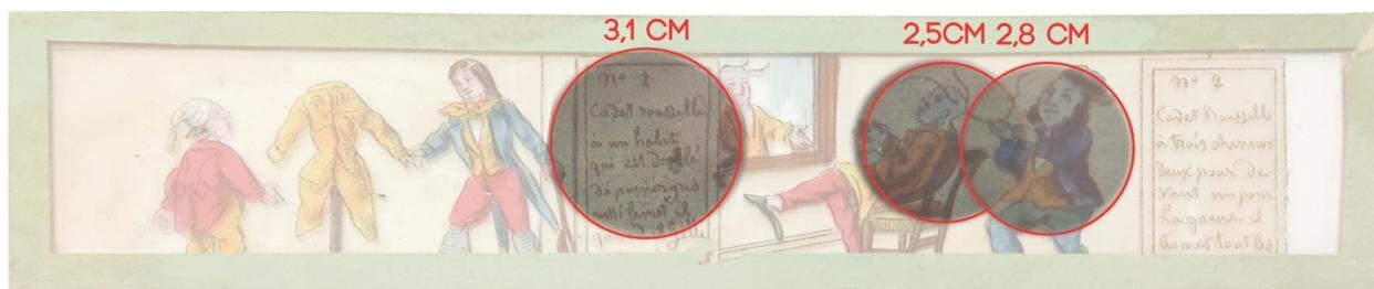
Figure 18. Mesure du diamètre des images projetées rapportées sur une image de la même plaque numérisée.
