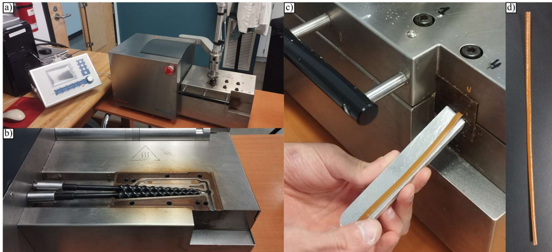
Figure 3.3 : Préparation du masterbatch : a) mini-extrudeuse Haake Minilab II, b) système interne de double vis, c) extrusion du masterbatch, d) masterbatch refroidi
