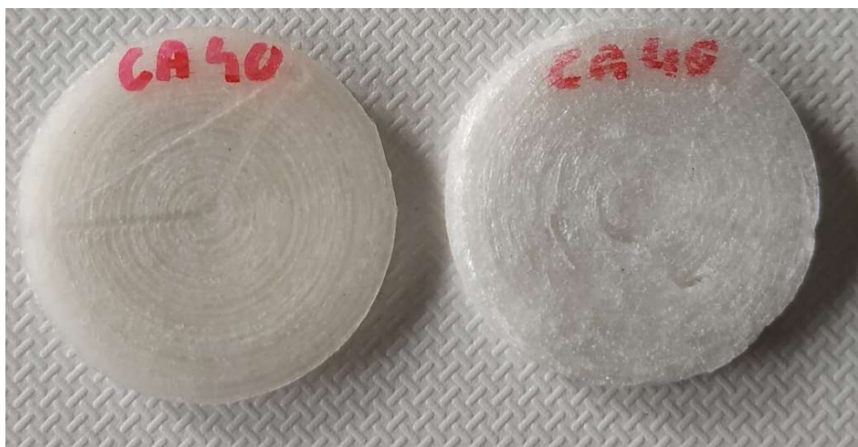
Figure 5.27 : Éprouvettes de CA-40 imprimé en 3D. Le filament a été étuvé à 60 °C durant 3h pour l'éprouvette de gauche tandis que celle de droite n'a pas été étuvée
