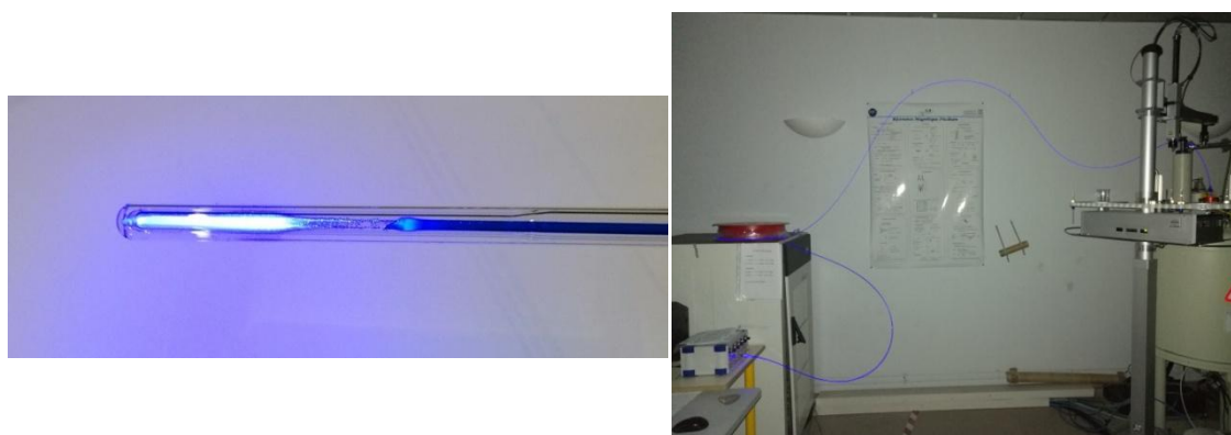
Figure 12 : Insert pour tubes RMN (à gauche), et la fibre optique allant dans la RMN (à droite)
