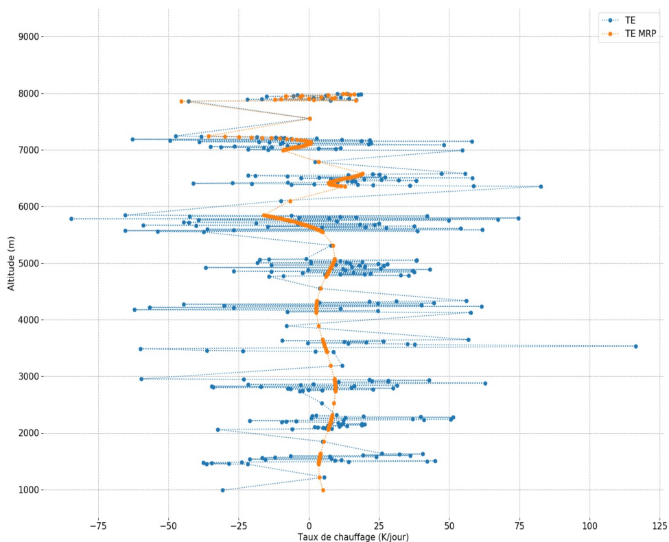
Figure III.1 : Un résultat du calcul du taux d'échauffement obtenu à partir des mesures de flux est représenté en bleu. La courbe orange est obtenue à l'aide d'une méthode de modélisation polynomiale. Les mesures ont été acquises lors de la descente en boucle réalisée le 8 septembre 2017. Cette descente a été réalisée au-dessus d'une scène nuageuse, située au large des côtes namibiennes.
