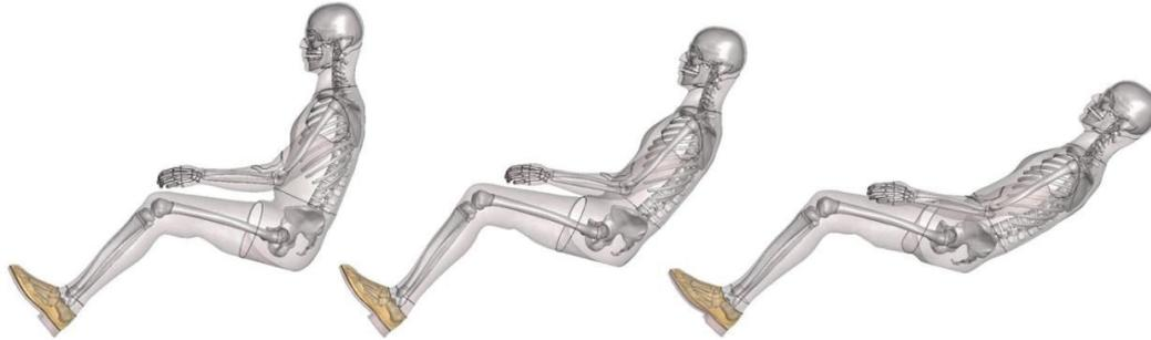
Figure 12. Modèle GHBMC M50-O positionné pour diverses inclinaisons de dossier d'après Grébonval et al. (2021).
