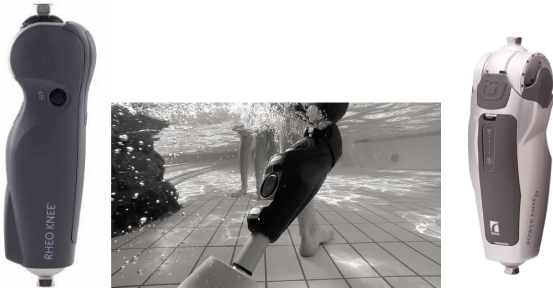
Figure 11 : Exemples de genoux MPK, à gauche le RHEO Knee de Ossur, au centre le Genium de Ottobock, et à droite le Power Knee de Ossur
