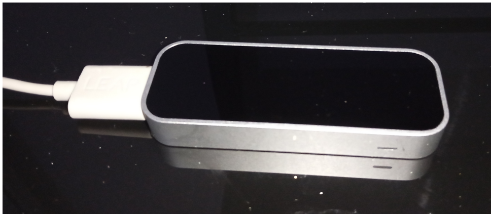
FIGURE 3.2 – Le contrôleur Leap Motion, capteur de mouvements de la main.
