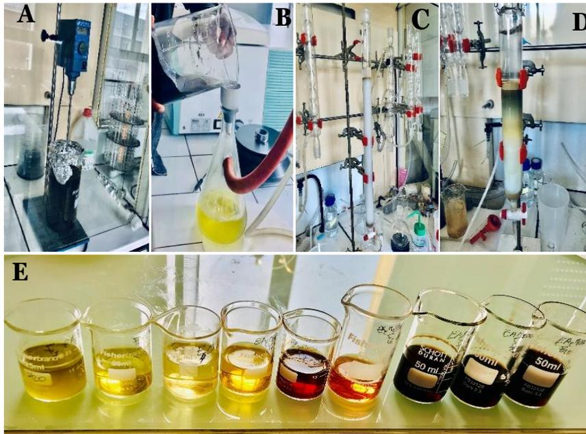
**Figure 29** : Procédure d'extraction et fractionnement : extraction par macération sous agitation (A) ; filtration (B) ; chromatographie sur colonne (C, D) et fractions (E)
