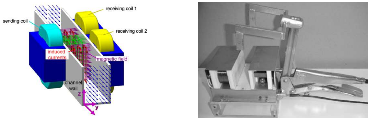
FIGURE 3.11: (a) Schéma et (b) modèle expérimental du concept de phase-shift flowmeter utilisé pour compenser les effets de la conductivité électrique du fluide sur la mesure de débit [55].
