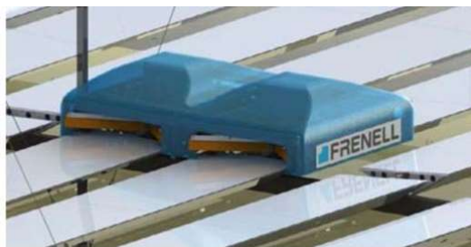
Figure I.25 : Robots de nettoyage Frenell se déplaçant sur deux lignes de réflecteurs primaires [31]
