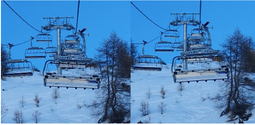
FIGURE 5.46: Balancement transversal des véhicules qui accompagne le pompage du câble sur la ligne des Verneys (document Doppelmayr)
