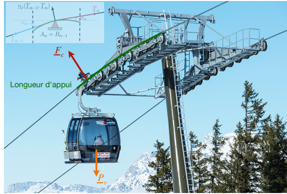
FIGURE 5.26: Franchissement d'un appui par un véhicule
