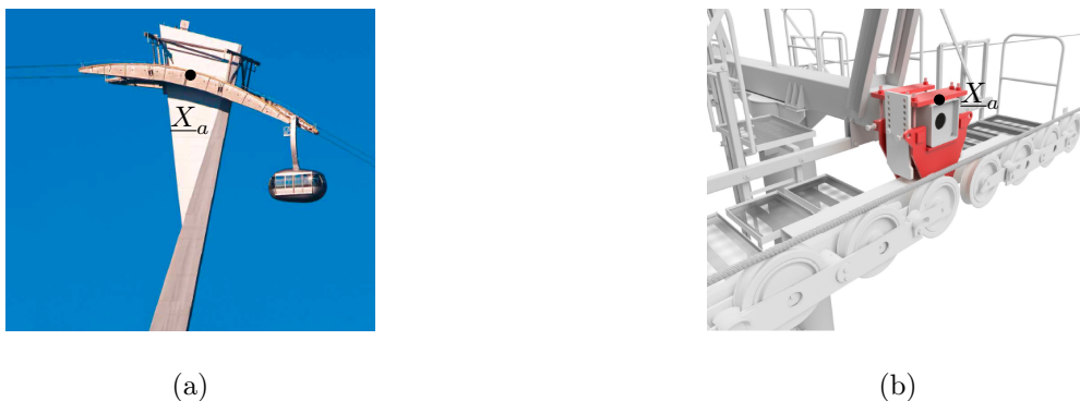
FIGURE F.7: (a) Photo d'un sabot d'appui des câbles d'un téléphérique (d'après une brochure Doppelmayr Group). (b) Vue de synthèse d'un appui balancier (d'après une brochure Rowema)
