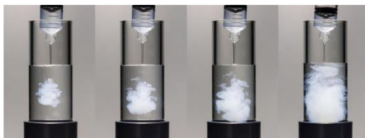
Figure 10 : Photographies à différents temps après l'ajout d'eau à de l'Ouzo. Observation de l'apparition du trouble suite à la nucléation des gouttelettes d'huile dans l'eau. 44
