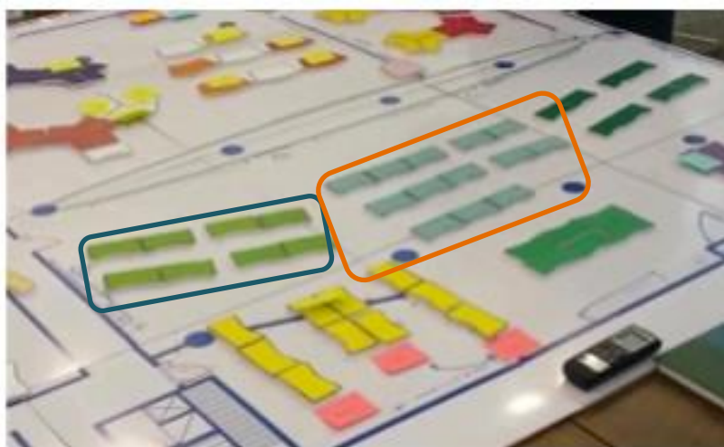
Figura 30 – Alteração da posição dos postos de trabalho das equipes de PP e GM para que fiquem uma do lado da outra durante a segunda etapa de simulação
