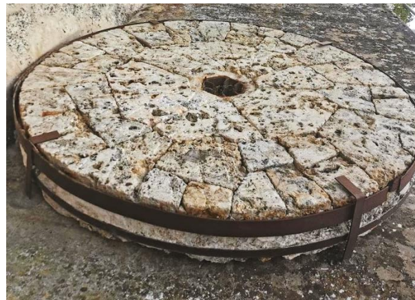
Figure 297. Meule composite en meulière de la Ferté-sous-Jouarre. © Le Pays Briard. Environ 2 m de diamètre.
