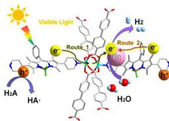
Figure 48 : photo-production d'hydrogène à partir de MOF@BODIPY-Pt 139 .
