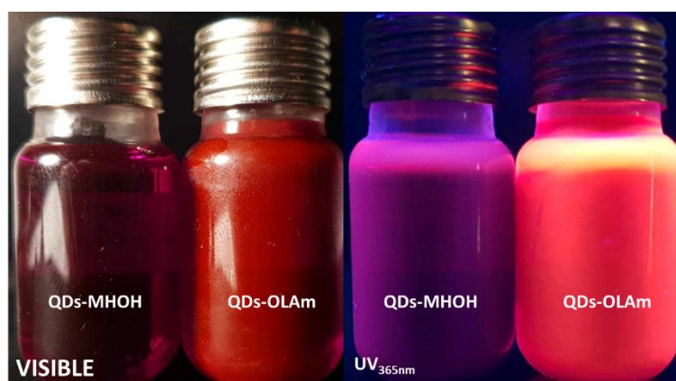
Figure 99 : Suspension de QDs échangés par MHOH dans le DMF et suspension de QDs dans du chloroforme sous lumière visible (gauche) et sous UV à 365 nm (droite).
