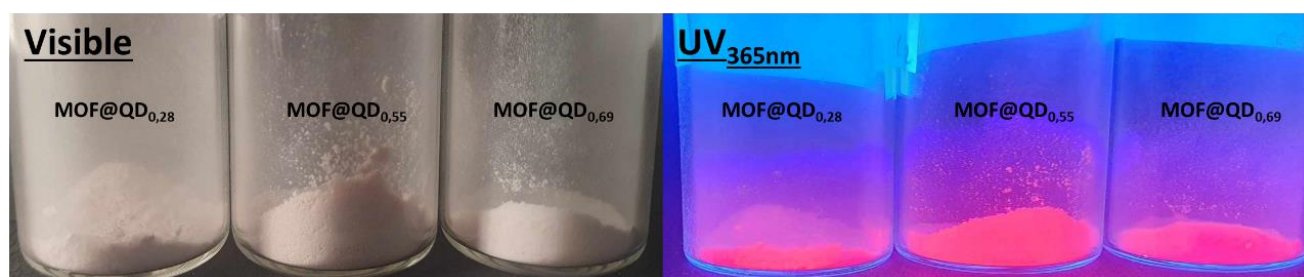
Figure 105 : Photos des échantillons MOF-5@QDs synthétisés avec respectivement 0,1 ; 0,2 et 0,3 mL de suspension de QDs par méthode "bottle around the ship" sous lumière visible et sous UV 365nm .
