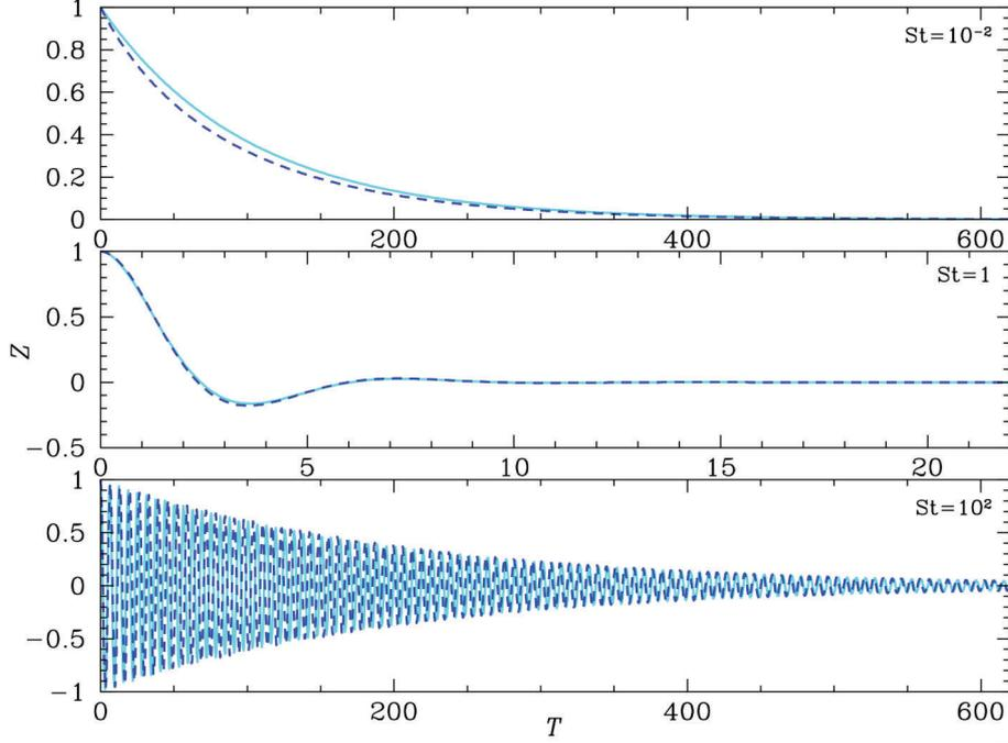
FIGURE 2.12 – Sédimentation verticale de la poussière dans les trois différents régimes. Ici,  $Z$  et  $T$  correspondent à  $\tilde{z}$  et  $\tilde{t}$ . Lorsque le nombre de Stokes  $St \sim 1$ , alors la sédimentation, tout comme la dérive radiale, est la plus rapide (Laibe et al., 2014).
