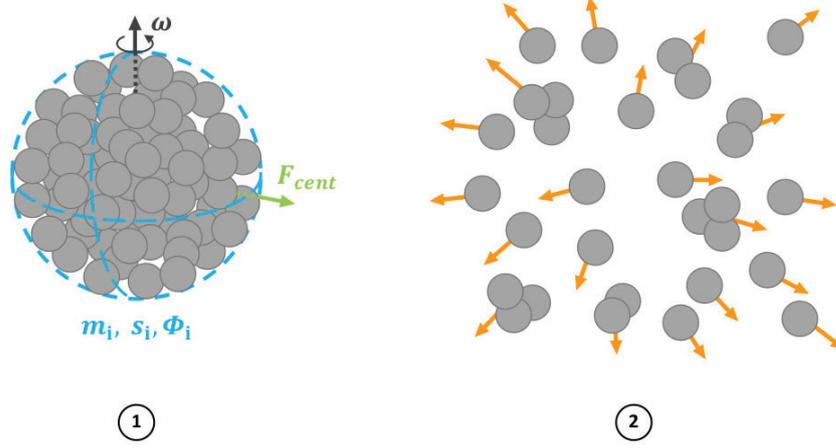
FIGURE 3.13 – 1 : Lorsqu'un grain sphérique de masse  $m$ , de facteur de remplissage  $\phi$ , et de vitesse angulaire  $\omega_c$ , se met à tourner trop rapidement, la force centrifuge devient plus grande que la résistance maximum à la traction et 2 : le grain vole en éclat.
