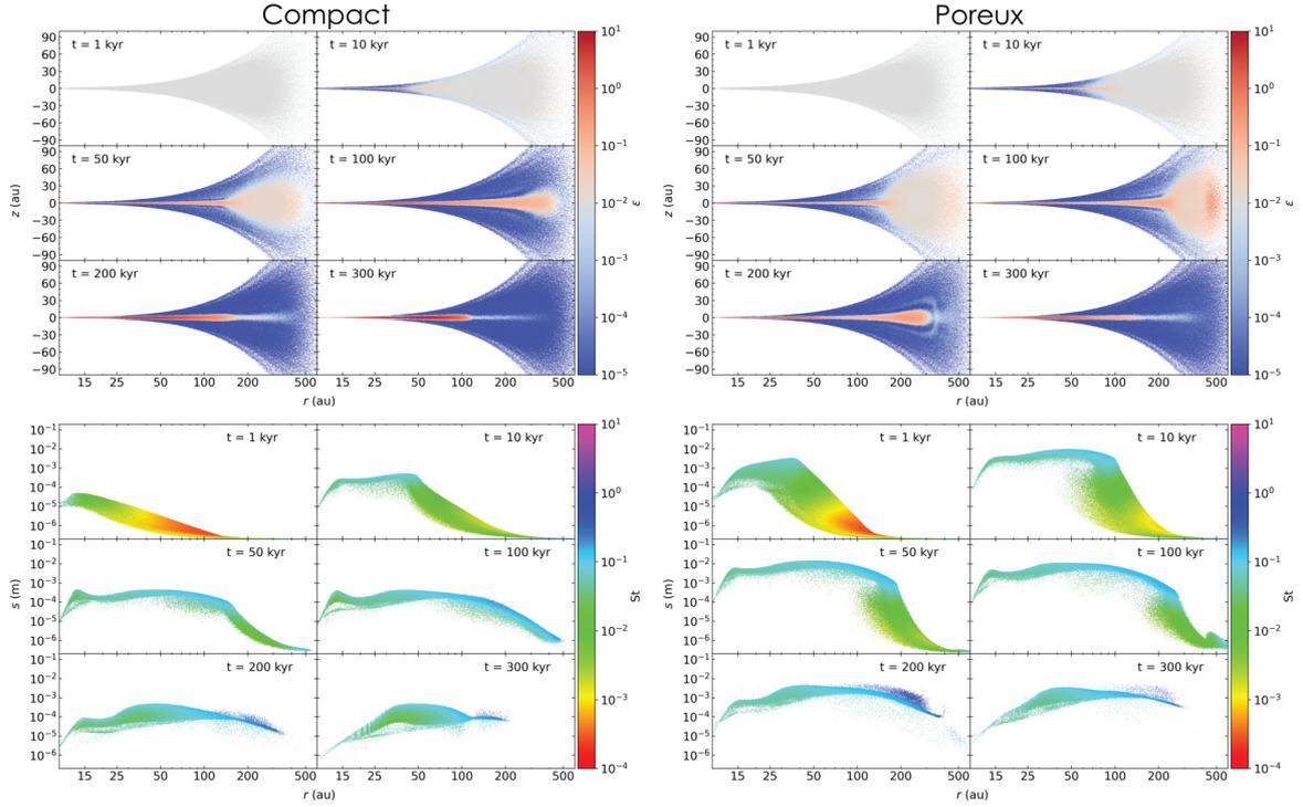
FIGURE 5.3 – Comparaison entre la simulation GF-Si-comp-Vf20 à gauche et GF-Si-a02-Vf20 à droite. Les panneaux du haut montrent la hauteur  $z$  en fonction de la distance  $r$ , la couleur donnant le rapport poussière/gaz. Ceux du bas montrent la taille des grains  $s$  en fonction de la distance, la couleur indiquant le nombre de Stokes  $St$ .
