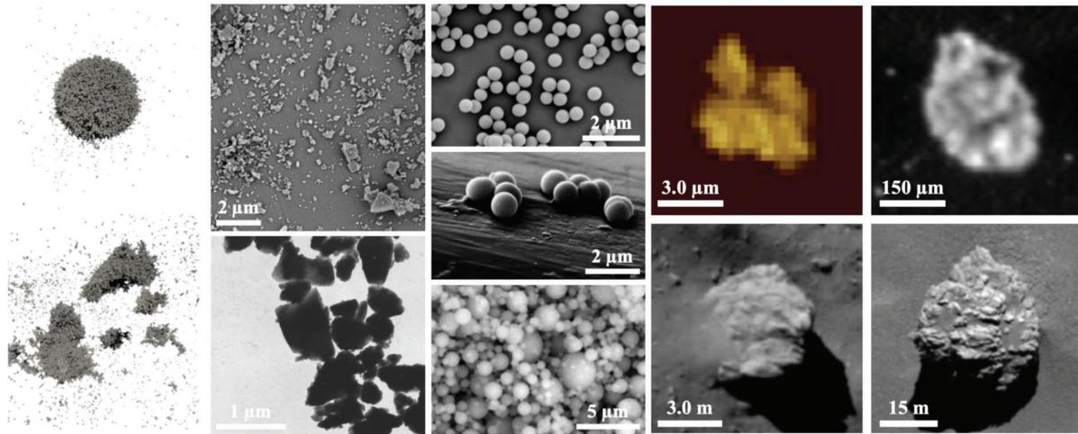
FIGURE 1.9 – **Gauche** : Agrégats poreux simulés numériquement après collision. Selon la vitesse relative lors de la collision, l’agrégat perd soit quelques monomères, soit se fragmente complètement (Seizinger et al., 2012). **Milieu et droite** : Différents agrégats plus ou moins poreux produits en laboratoire sur les cinq panneaux du milieu et observés sur la comète 67P/Tchourioumov-Guérassimenko pour les quatre panneaux de droite (Güttler et al., 2019).
