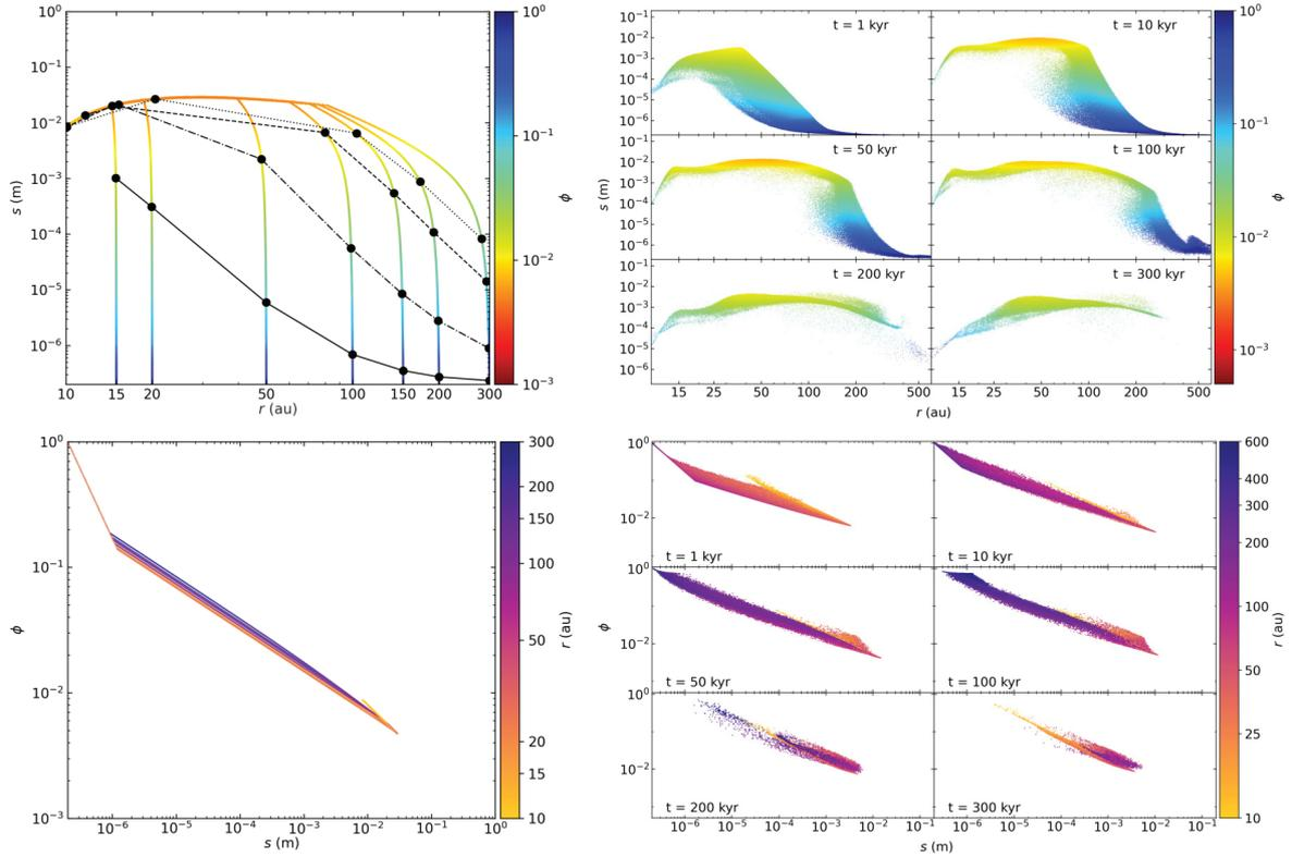
FIGURE 5.6 – Comparaison entre PAMDEAS à gauche et PHANTOM à droite pour la simulation GF-Si-a02-Vf20. Les panneaux du haut montrent la taille  $s$  selon la distance à l'étoile  $r$ , la couleur indiquant le facteur de remplissage  $\phi$ . Les panneaux du bas montrent l'évolution couplée du facteur de remplissage  $\phi$  et de la taille  $s$ . La couleur donne la distance  $r$ . Attention, les échelles sont différentes selon le code utilisé.
