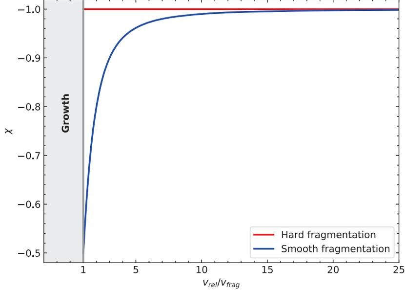
FIGURE 3.1 – Comparaison entre les deux modèles de fragmentation. En rouge, le modèle de fragmentation dure avec  $\chi = -1$  et en bleu le modèle développé par Kobayashi & Tanaka (2010) et Garcia (2018)
