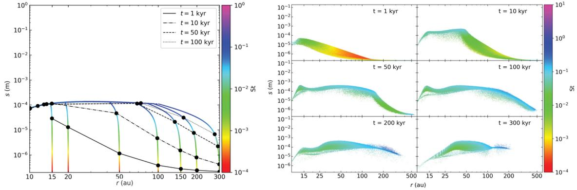
FIGURE 5.5 – Comparaison entre PAMDEAS à gauche et PHANTOM à droite pour la simulation GF-Si-comp-Vf20. Les panneaux montrent la taille  $s$  selon la distance à l'étoile  $r$ , la couleur indiquant le nombre de Stokes. Attention, les échelles sont différentes selon le code utilisé.
