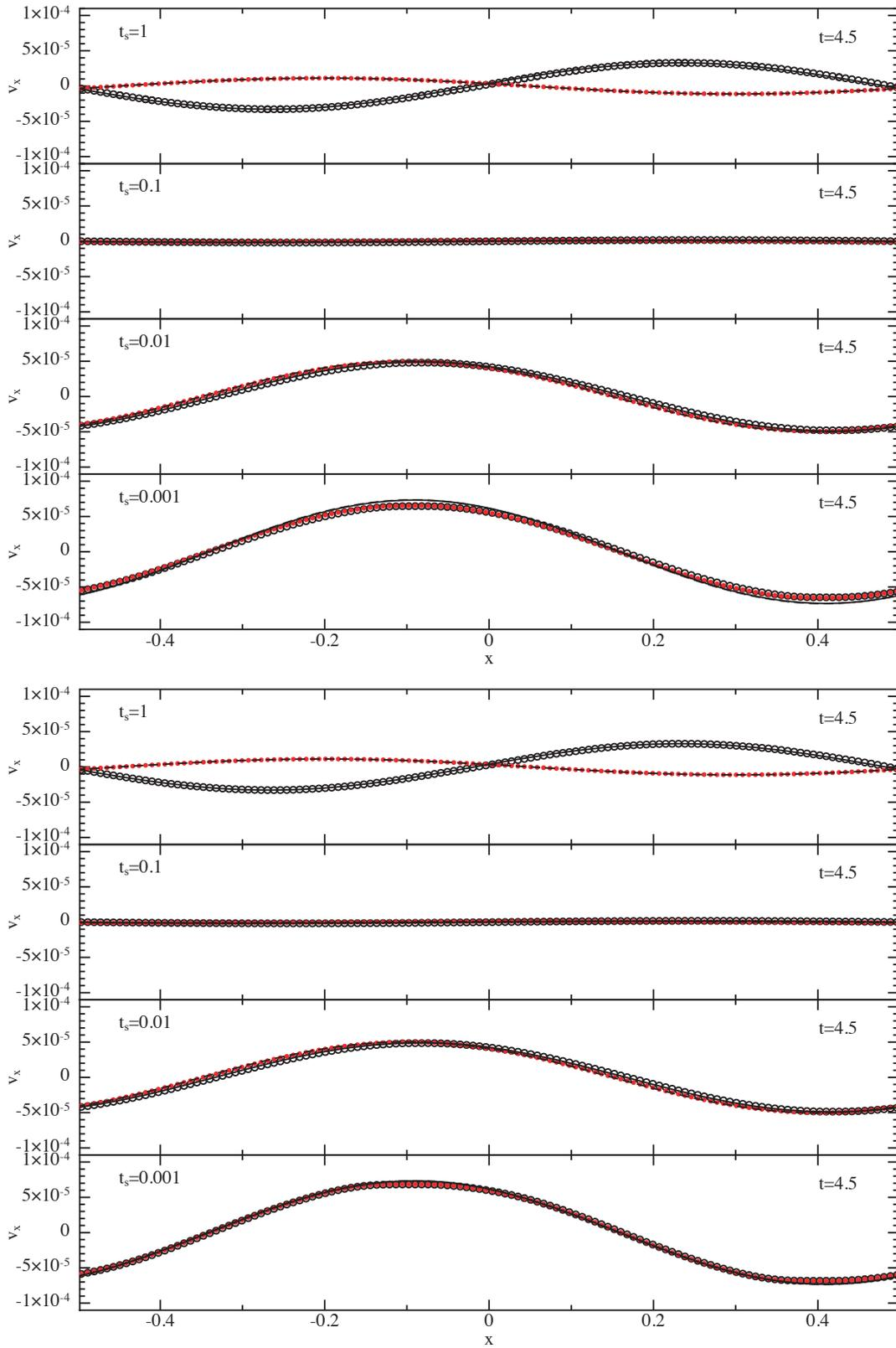
FIGURE 4.4 – Vitesse du gaz (ligne) et de la poussière (cercle) à  $t = 4.5$ , en utilisant la méthode bi-fluide et un rapport poussières-gaz de 1. Les résultats sont donnés pour  $K = 0.5, 5, 50$  et  $500$  (haut en bas), correspondant au temps d'arrêt indiqué.
