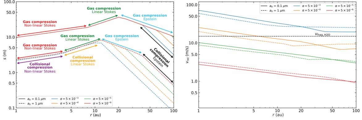
FIGURE 6.1 – La taille maximum des agrégats (gauche) et vitesse relative entre les grains (droite) avant la rupture par rotation pour différents paramètres de viscosité turbulente  $\alpha_{ss}$  et différentes tailles de monomère  $a_0$  pour de la glace d'eau dans un disque MMSN. La ligne en tiret noir donne pour référence le seuil typique de fragmentation pour la glace d'eau.
