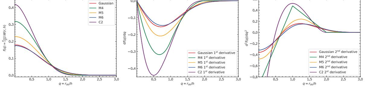
FIGURE 4.2 – Différentes fonctions de lissage à gauche et leur dérivée première au centre et seconde à droite. On retrouve la gaussienne, les fonctions B-splines  $M_4$  à  $M_6$ , et la fonction de Wendland  $C_2$ . La fonction reproduisant le mieux la gaussienne est la fonction  $M_6$ .
