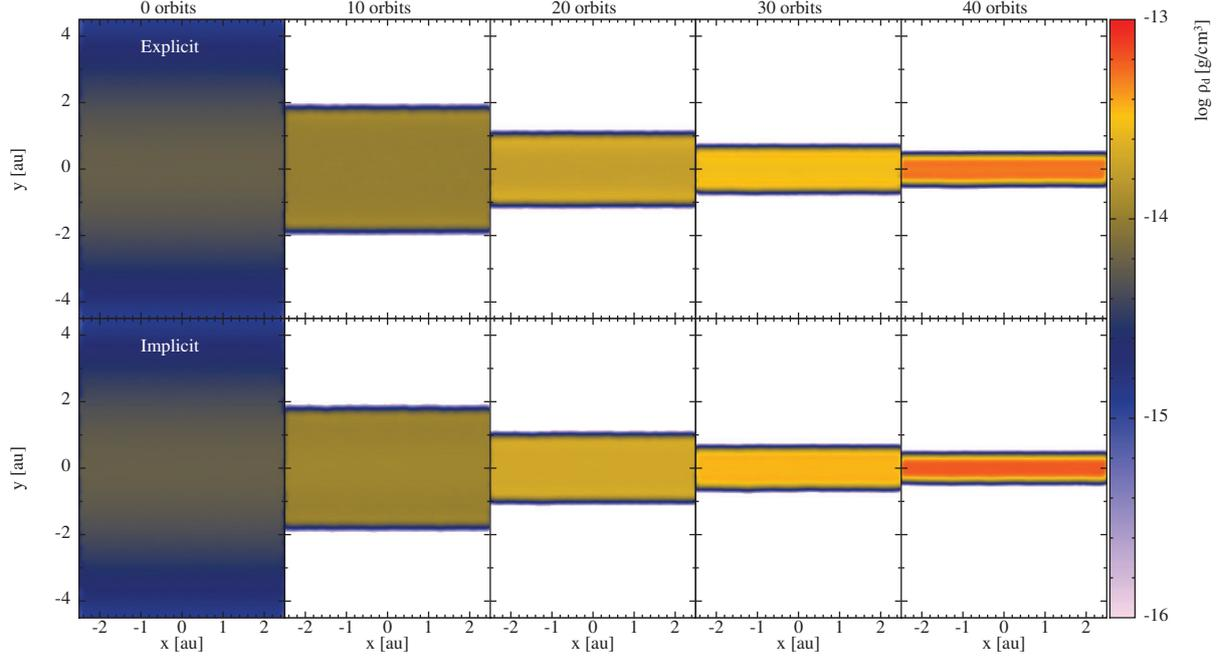
FIGURE 4.5 – Version 3D du test de [Price & Laibe \(2015\)](#), montrant la densité de poussière dans le plan ‘ $r - z$ ’ du disque. La poussière utilisée correspond à des grains de 1 mm et un rapport  $\varepsilon = 1\%$ , dans l’atmosphère stratifiée du disque avec  $H_g/r_0 = 0.05$  et  $r_0 = 50$  ua (équation(4.89)). En haut, la simulation est réalisée avec le schéma explicite, en bas avec le schéma implicite, toutes les deux en bi-fluide.
