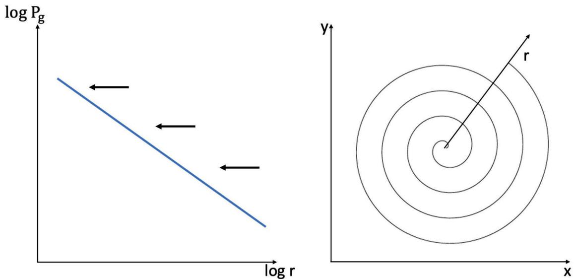
FIGURE 2.8 – **Gauche** : La poussière dérive toujours vers le maximum de pression du gaz, généralement situé sur le bord interne du disque. **Droite** : Cette friction entre la poussière et le gaz fait qu’en dérivant, la poussière spirale vers le bord interne du disque.
