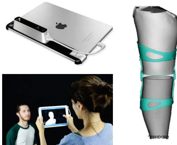
Figure 38 : Création sur mesure de l'orthèse à partir des données de numérisation 3D (Ipad + Structure Sensor) de la morphologie du membre inférieur du patient. (Illustrations fournies par le laboratoire Médicus)
