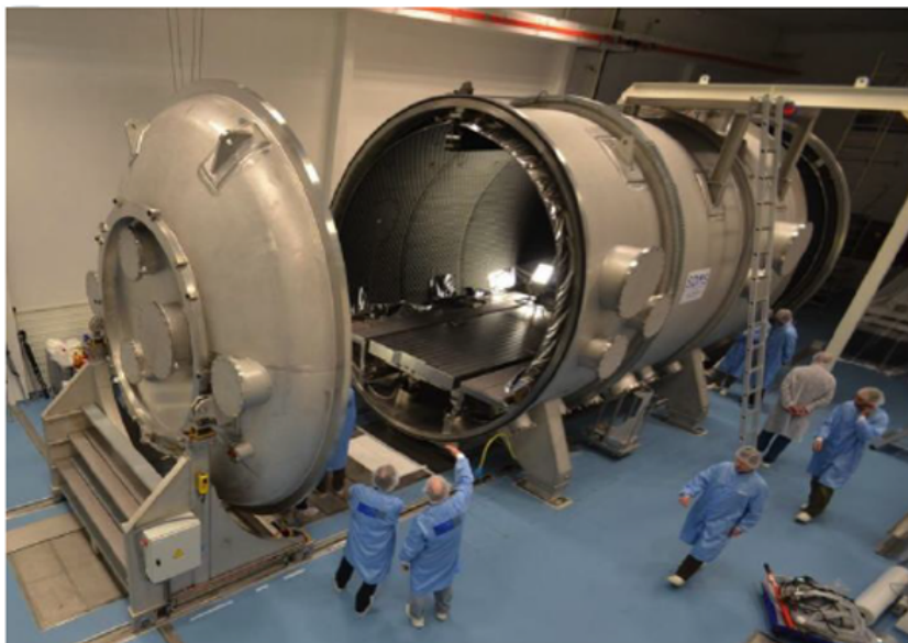
FIGURE 4.8 – Photo de la cuve ERIOS au LAM. La photo est prise avant que le banc ZIFO, dans son écran thermique (cf. Fig.4.6) fermé, soit installé sur la table isolée. La table repose, non pas sur l'intérieur de la cuve, mais sur un bloc isolé sismiquement et se trouvant sous le sol de la salle
