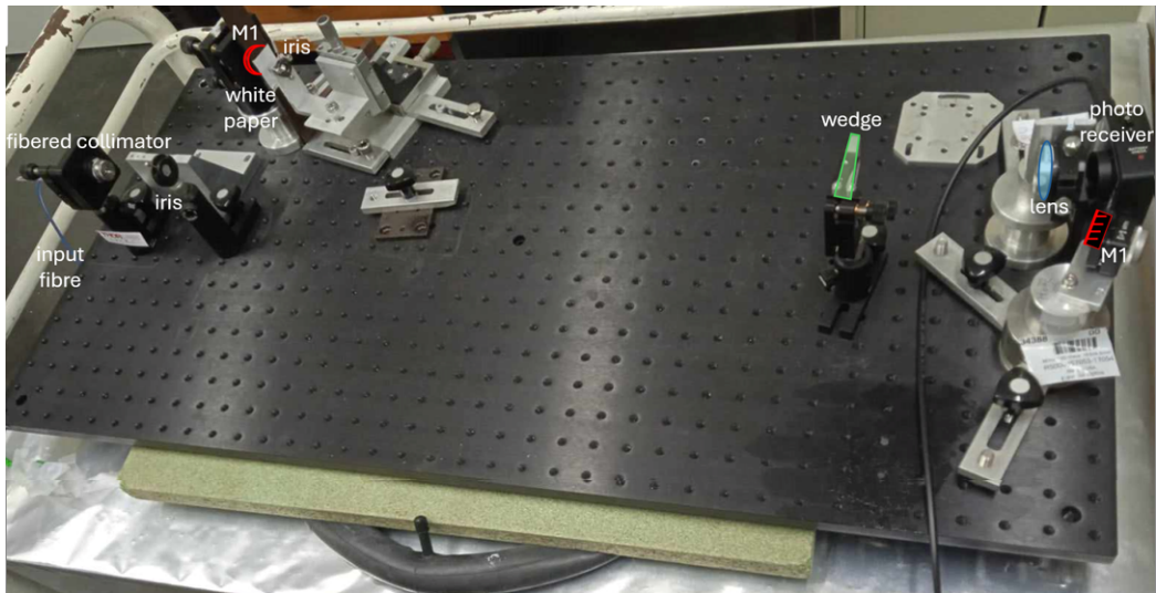
FIGURE 4.2 – Photo du "simulateur de MOSA" (schéma Fig.4.1) avec le point trait-plan (planche verte) soutenant la table optique, la chambre à air et le diffuseur blanc placé devant le miroir M1, partiellement caché. Les miroirs sont rehaussés de rouge, la lame prismatique en vert, la lentille en bleu.
