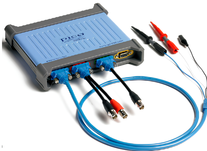
FIGURE 3.24 – Photo du Picoscope 4444 et de sa connectique de base
